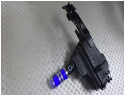
延長カプラーとセンサー側をカプラーオン
