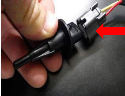
延長カプラーとセンサー側をカプラーオン
